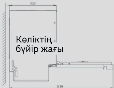
В сурет ыдыс жуғыш машинаның есігін ашу схемасы
