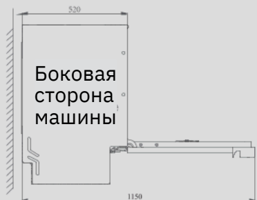
Рисунок В Схема открывания дверцы посудомоечной машины
